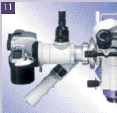
**Fig. 11** : Appareil photo adjoint au microscope.
